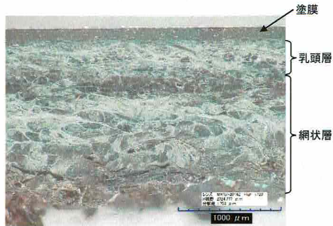
図3 試験片の表面に対して垂直方向の断面写真
