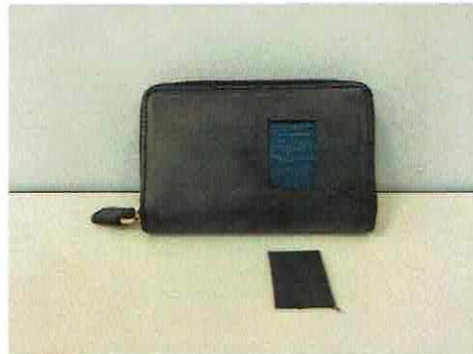
図 2 試験片の採取箇所および試験片の写真
